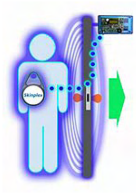
Abbildung 14: Datenübertragung über die menschliche Haut mit der Skinplex Technologie. Quelle Abbildung: IDENT Technologie AG
